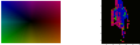
(a) Encodage chromatique des vecteurs de mouvement. (b) Vecteurs de mouvements estimés (amplifiés).
